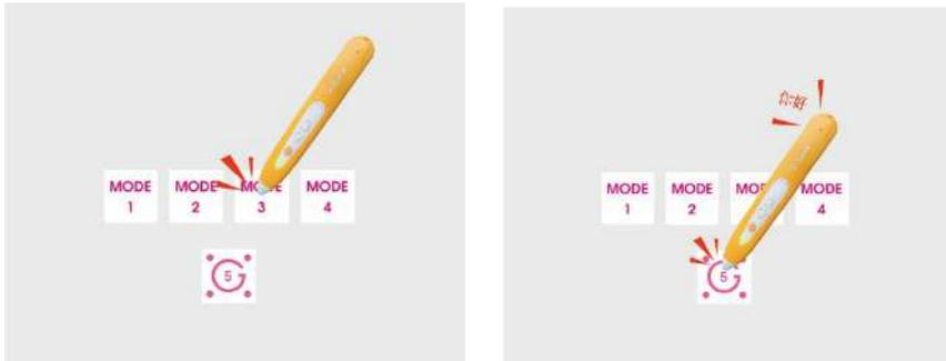
モード 4 を選択してから 5 番のドットにタッチすると MODE4 に設定した「안녕하세요」(韓国語)の音声が流れます。
