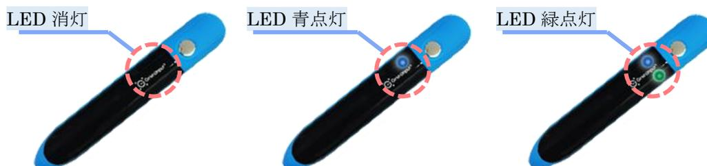
図 9 左：電源オフ、中央：電源オン、右：接続成功
