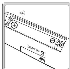
④図のような電池の向きで収まっていることを確認したら電池カバーを閉じ、ネジを締めます。
