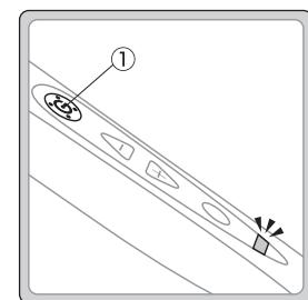
① G-Speak の電源ボタンを押して、電源を ON にします。電源が ON になると、表示 LED が緑に点灯します。
