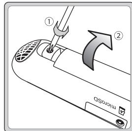
①プラスドライバーを用意して、反時計回りにネジを回して外します。
