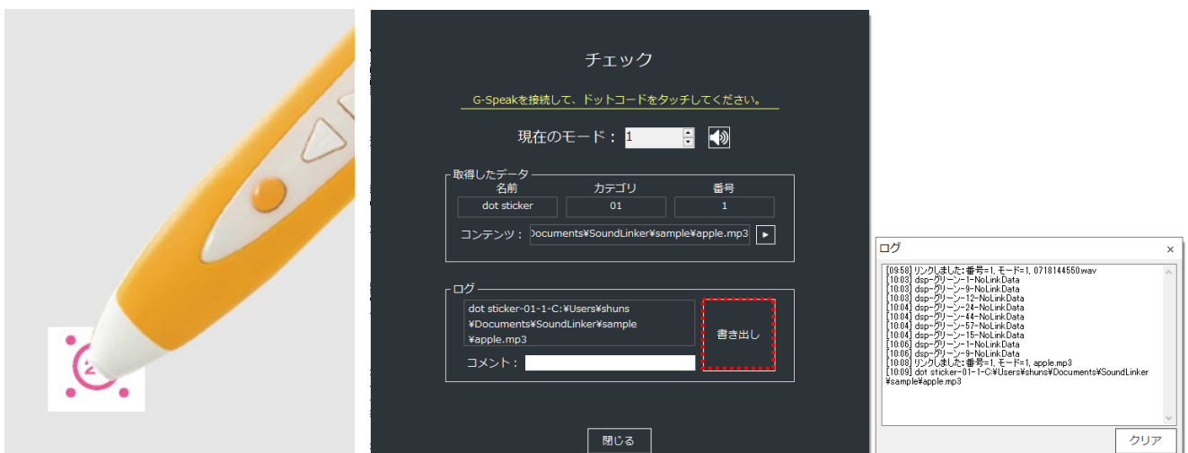
図 7.1-3 ドットコードにリンクされているデータをチェックする
